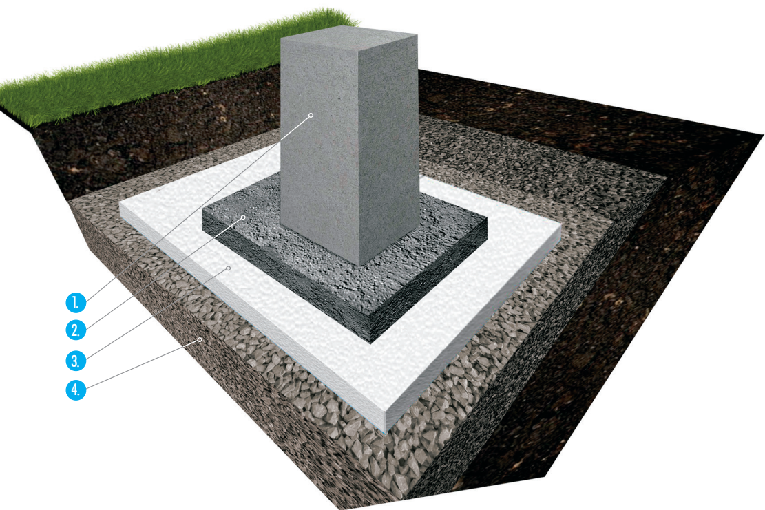
Рис. 25. Схема укладки теплоизоляции из пенополистирольных плит KNAUF Therm® Пол PRO и KNAUF Therm® 5 in 1 F в столбчатых фундаментах:
