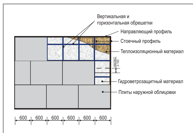
Рис. 22. Крепление наружной обшивки к каркасу
