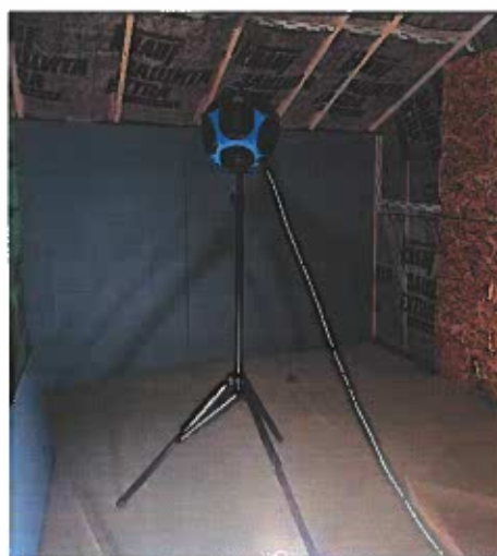
Фото 2. Измерение времени реверберации в помещении низкого уровня звукового давления
