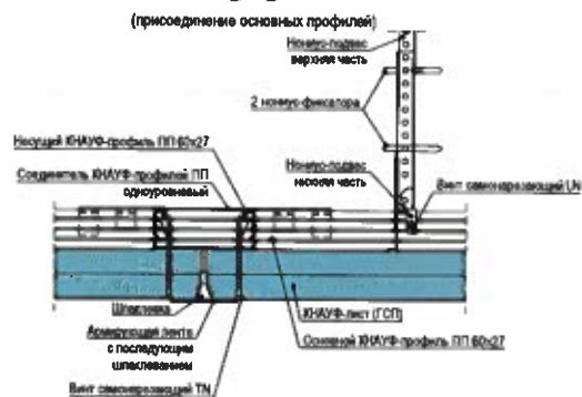
Г - Г (присоединение основных профилей)
