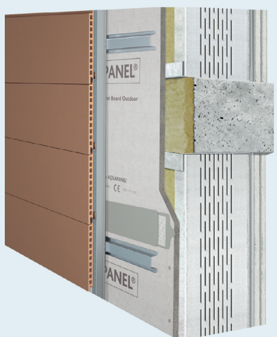
Облицовка терракотовой плиткой
