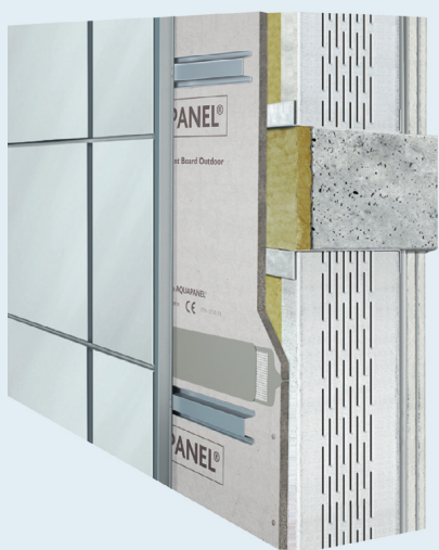
Облицовка алюминиевыми кассетами
